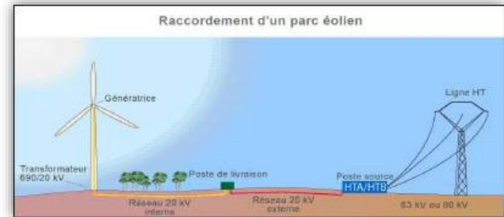
Figure 29 : Organisation générale du raccordement électrique au réseau de distribution
